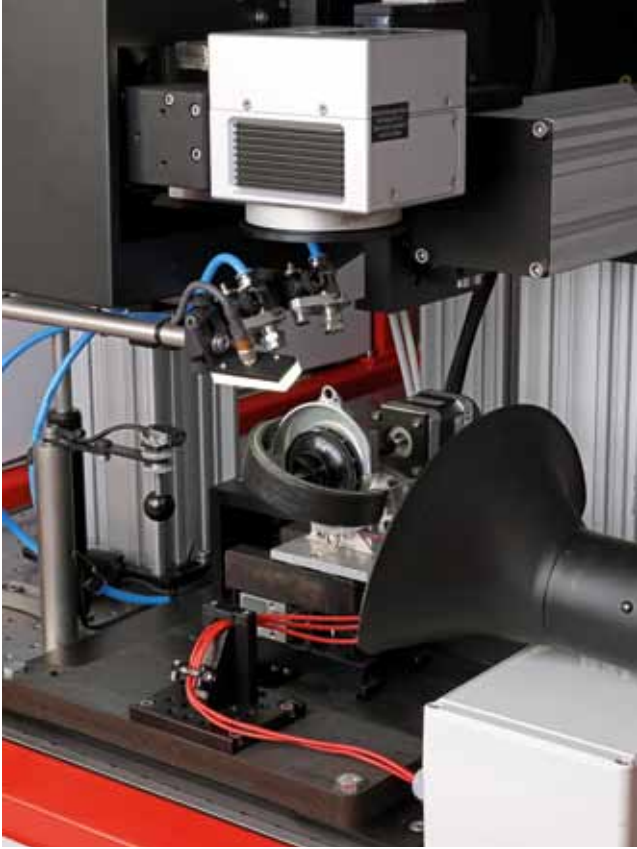
系统配备方便取放涡轮的夹具
