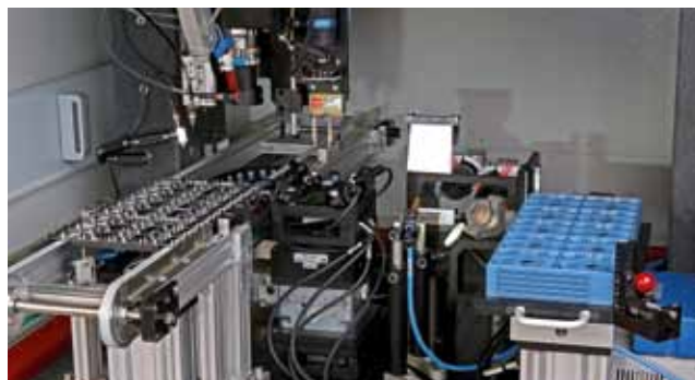
通用式上料盘配合传送带可以将系统接入到全自动流水线。
