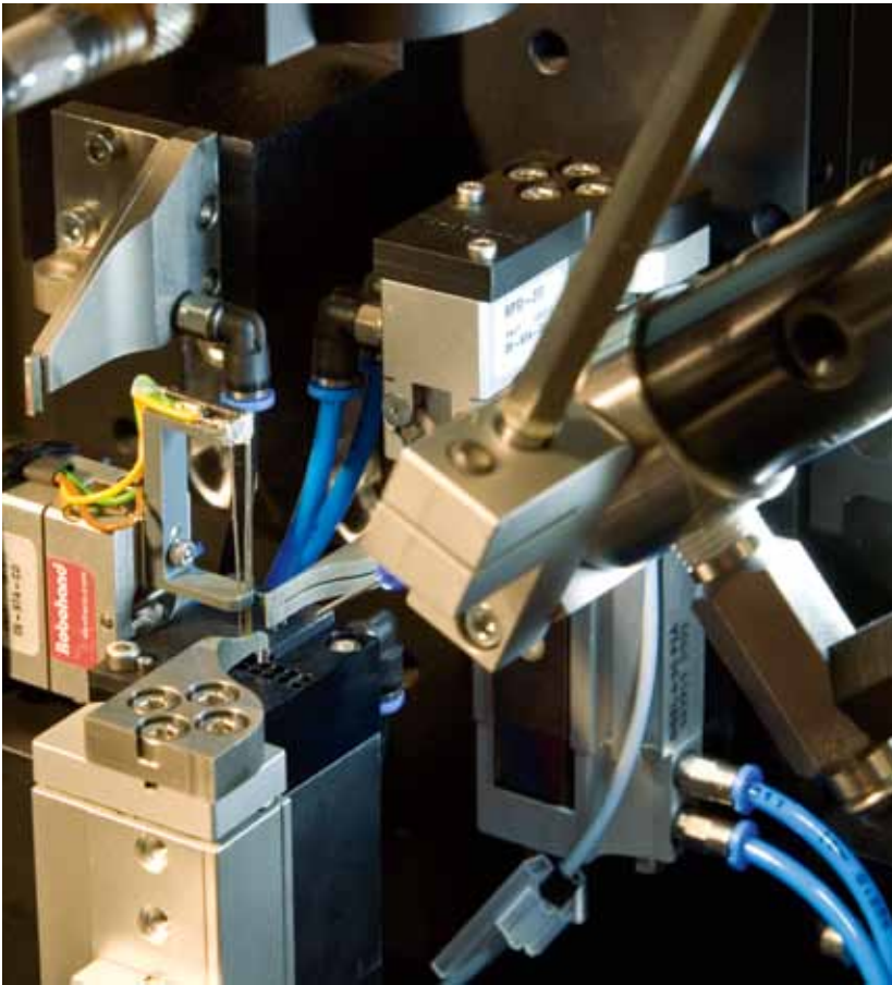
定制的夹具为光学元件耦合提供可靠的夹持
