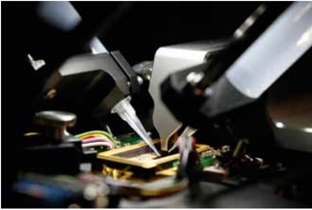
全自动的耦合点胶和UV固化系统
